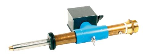
Über einen Skimmer wird die Fluidoberfläche abgesaugt. Der Skimmer ist selbstregelnd und passt sich kontinuierlich der Fluidoberfläche an und wird mittels Magnet am KSS\_Behälter befestigt. Die abgesaugten Flüssigkeiten werden sanft in einem Sedimentationsbehälter befördert.
