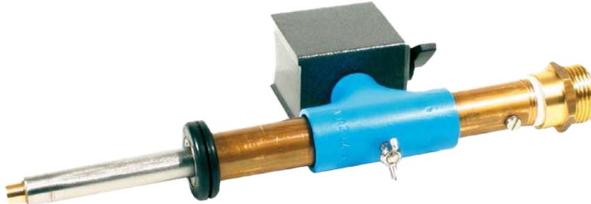
Über einen Skimmer wird die Fluidoberfläche abgesaugt. Der Skimmer ist selbstregelnd und passt sich kontinuierlich der Fluidoberfläche an und wird mittels Magnet am KSS\_Behälter befestigt. Die abgesaugten Flüssigkeiten werden sanft in einem Sedimentationsbehälter befördert.
